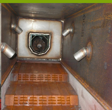
Камера сгорания HKRST 160 кВт
