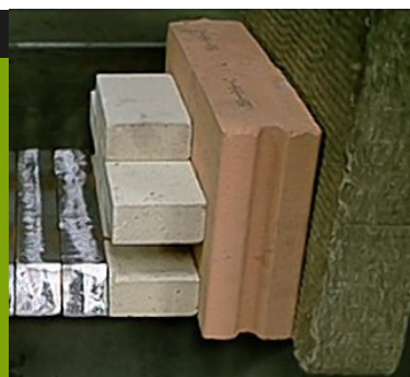
Изоляционные и футеровочные материалы котла и камеры
