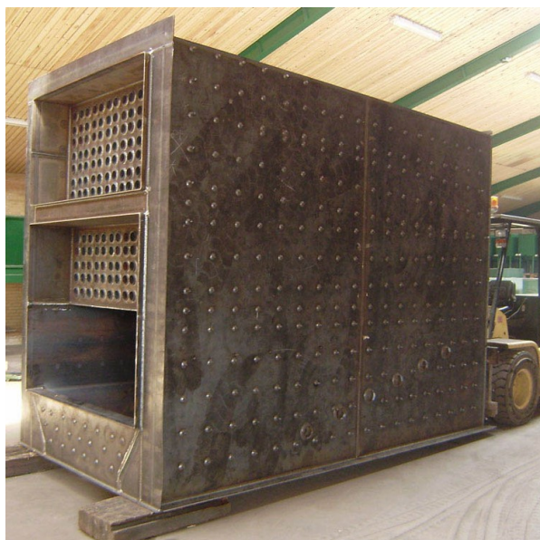
Строительство котла HKRST 2,8 MW
